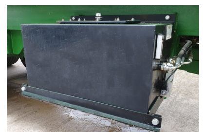
Deposito auxiliar aceite
