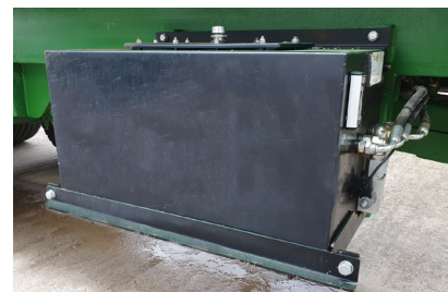
Deposito auxiliar aceite
